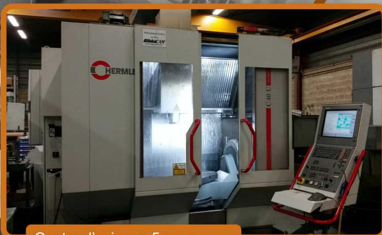
Centre d'usinage 5 axes C40U Hermlé
