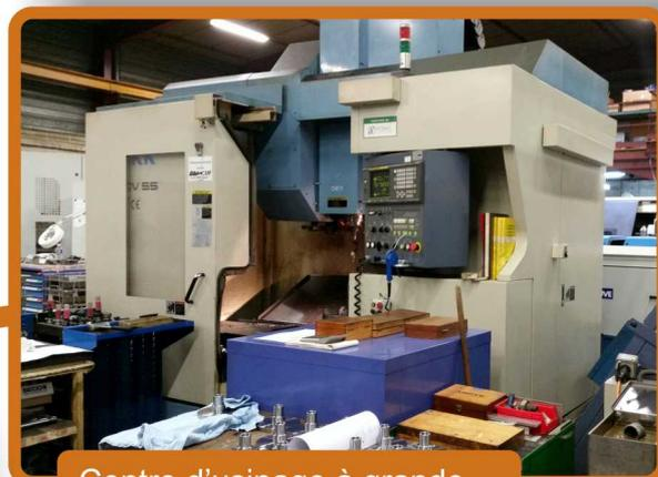
Centre d'usinage à grande vitesse 3 axes OKK
