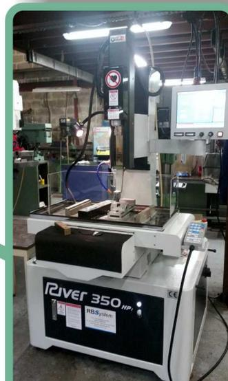
Perceuse rapide de précision par électroérosion
