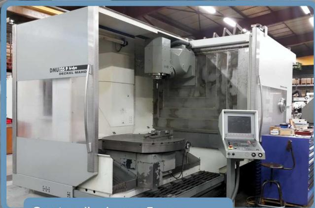
Centre d'usinage 5 axes DMU 125
