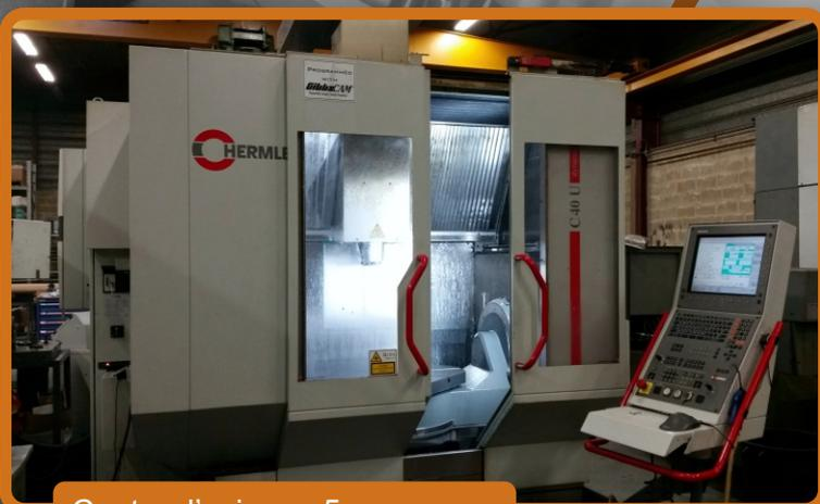
Centre d'usinage 5 axes C40U Hermlé
