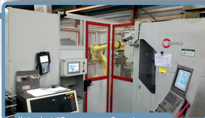
Ilot robot 12 axes avec 2 centres d'usinage 5 axes Hermlé
