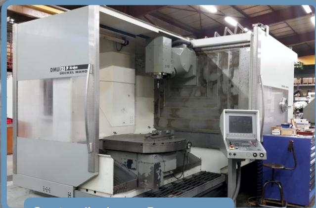
Centre d'usinage 5 axes DMU 125
